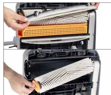
14. Снять скребок. Открутить, повернув рукоятку по часовой стрелке, чтобы удалить цилиндрическую щётку.
