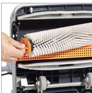
2. Проверить правильную установку и износ цилиндрической щётки.
