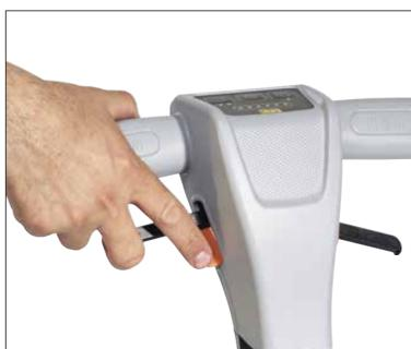
8. Для сбора мелкого мусора во время подметания следует поднять/заблокировать расположенный справа рычаг, чтобы поднять передний скребок.
