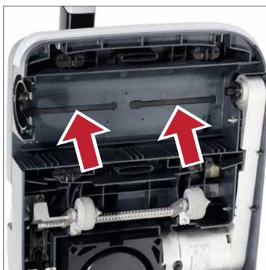
3. Проверить, не засорены ли отверстия в распределителях раствора. При необходимости, снять и очистить.
