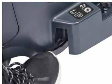
11. Для транспортировки и парковки машины следует нажать педаль (слегка приподнять переднюю часть машины, наклонив ручку).
