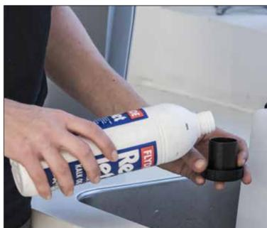
3. Крышка бака может использоваться для дозирования моющего средства. Объем крышки – 30 мл, что составляет 0,5% 6-литрового бака. (\*)
