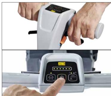
4. Установить ручку на соответствующую высоту. Включить машину, нажав главный выключатель.
